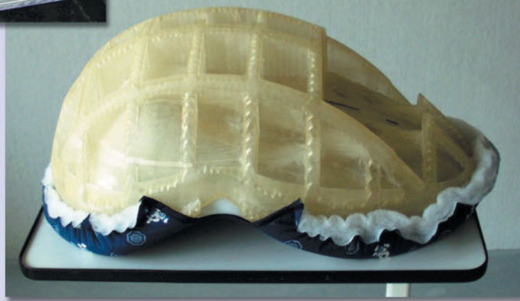
Die Stereolithographie-Schale verdeutlicht den Aufbau der Rippen, die bei einem Crash den Großteil der einwirkenden Kräfte abhalten sollen
