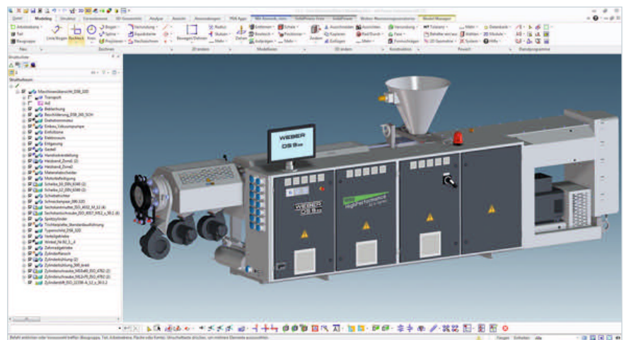
Die Kunststoffmaschinen bestehen zu großen Teilen aus Blechteilen, bei deren Modellierung das System dem Konstrukteur viele Fertigungsparameter vorgibt (Bild: Hans Weber)
